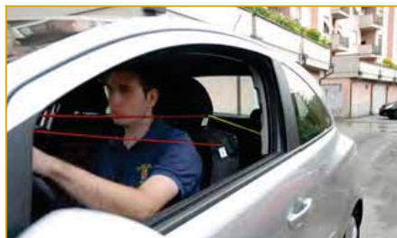
▲ Ricostruzione delle traiettorie dei frammenti di proiettile nell'abitacolo. Le asticelle colorate rappresentano la traiettoria dei frammenti
